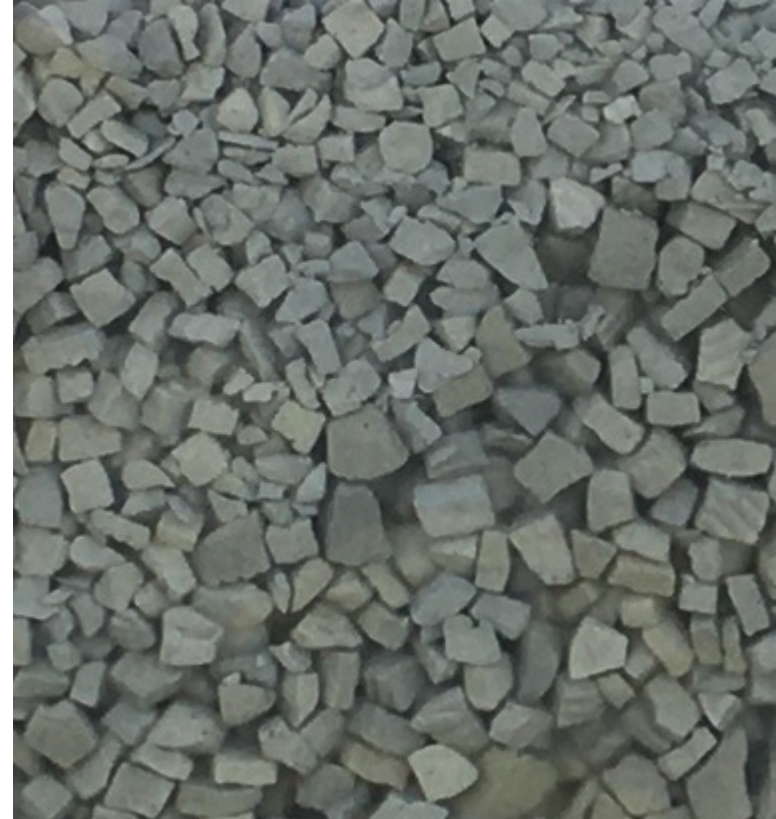
Vaahtolasi on kierrätystä jätelasista tehtyä uusiomateriaalia. Kuva: Spolia Design Oy.
