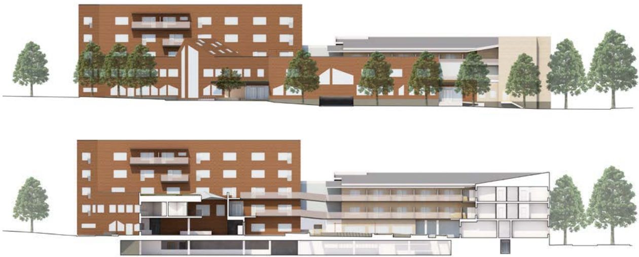
Kuvat 7 ja 8. Julkisivu ja leikkaus palvelukeskuksesta. Uudisrakennus erottuu tummempana. Leikkauksessa näkyy myös pysäköinti.
