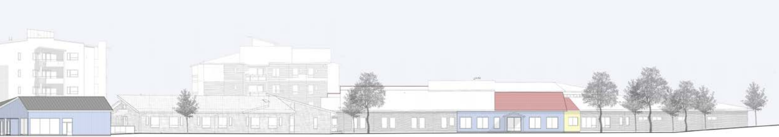
Kuva 51. Palvelukeskuksen julkisivu itään. Vasemmalla näkyvä lisärakennus jatkaa massoitte- taan olemassa olevan rakennuksen linjoja. Siniset värit julkisivuissa merkitsevät uusia, puiston puoleisia sisäänkäyntejä.
